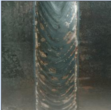
Acero carbono con MIG pulsada
